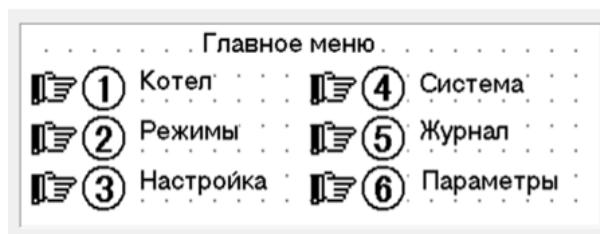
Для вызова экрана **Главное меню** нужно нажать кнопку ESC. На экране **Главное меню** имеется шесть кнопок, открывающих доступ к всем меню котла. Каждая меню имеет несколько экранов. Находить экраны достаточно просто, например нужен экран 3.3 - нажмите кнопку 2 и далее нажимайте кнопку ↓ пролистывая экраны 3.1 - 3.2 - 3.3.
