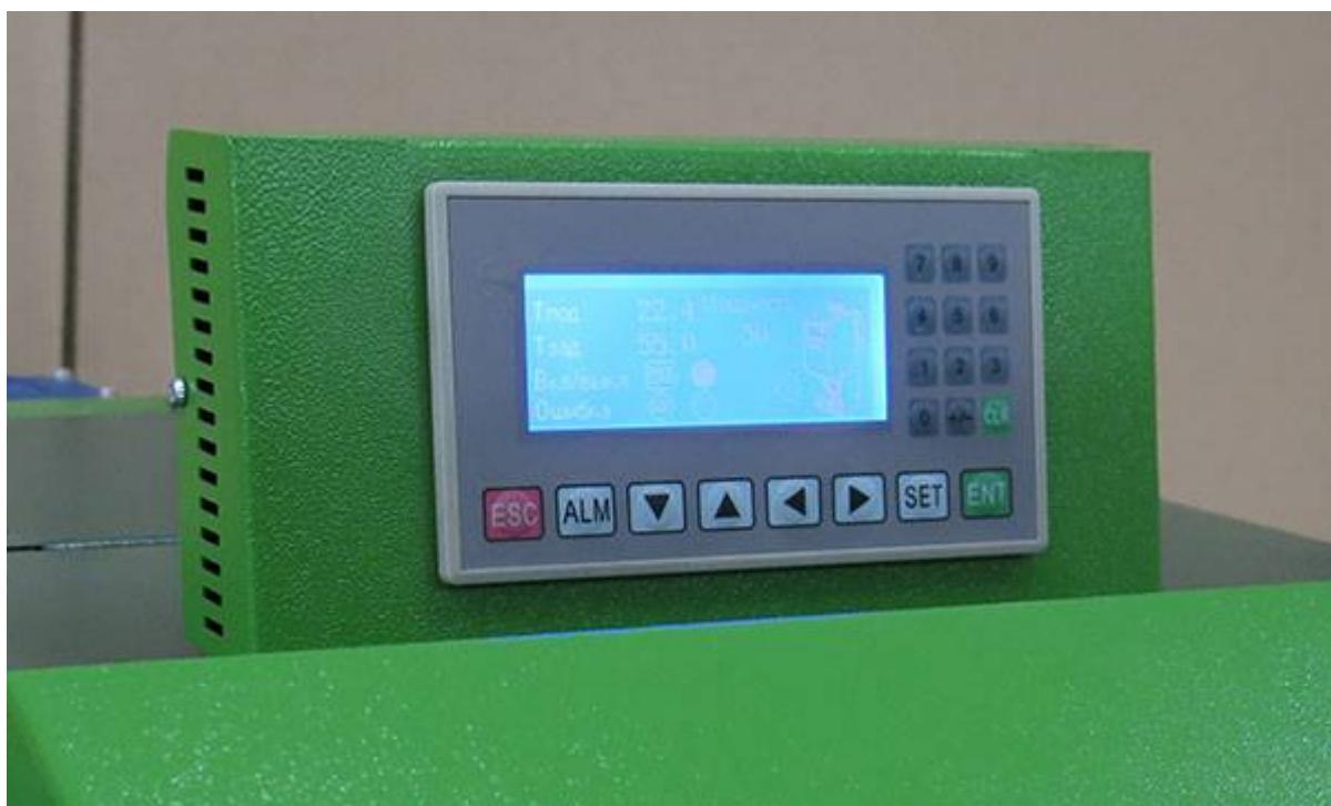
Контроллер имеет систему энергосбережения. После 30 минут бездействия экрана (отсутствия нажатий кнопок) экран перейдет в спящий режим. Для перехода в активный режим необходимо нажать любую кнопку.
