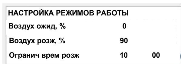
Показатель **Воздух ожидание** позволяет задать подачу воздуха в режиме **Ожидание**. При этом величине 0% соответствует частота дымососа примерно 6Гц (300 об/мин), а 100% 55Гц (3000 об/мин). Показатель применяется для противодействия обратной тяге при холодном котле.
