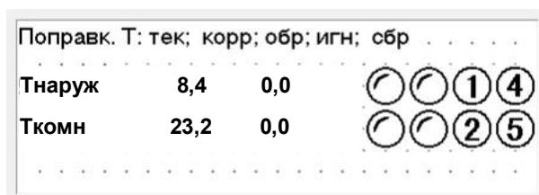
Экраны 3.6 и 3.7 - экраны коррекции значения датчиков температуры.
