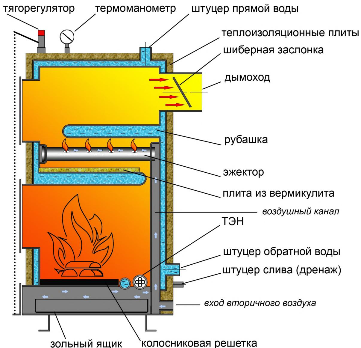
Рисунок 3 \_ Внутреннее устройство котлов «ТЕПЛОВЪ» серии «Модернъ» моделей ТМ - 10 ÷ 50 базовой комплектации
