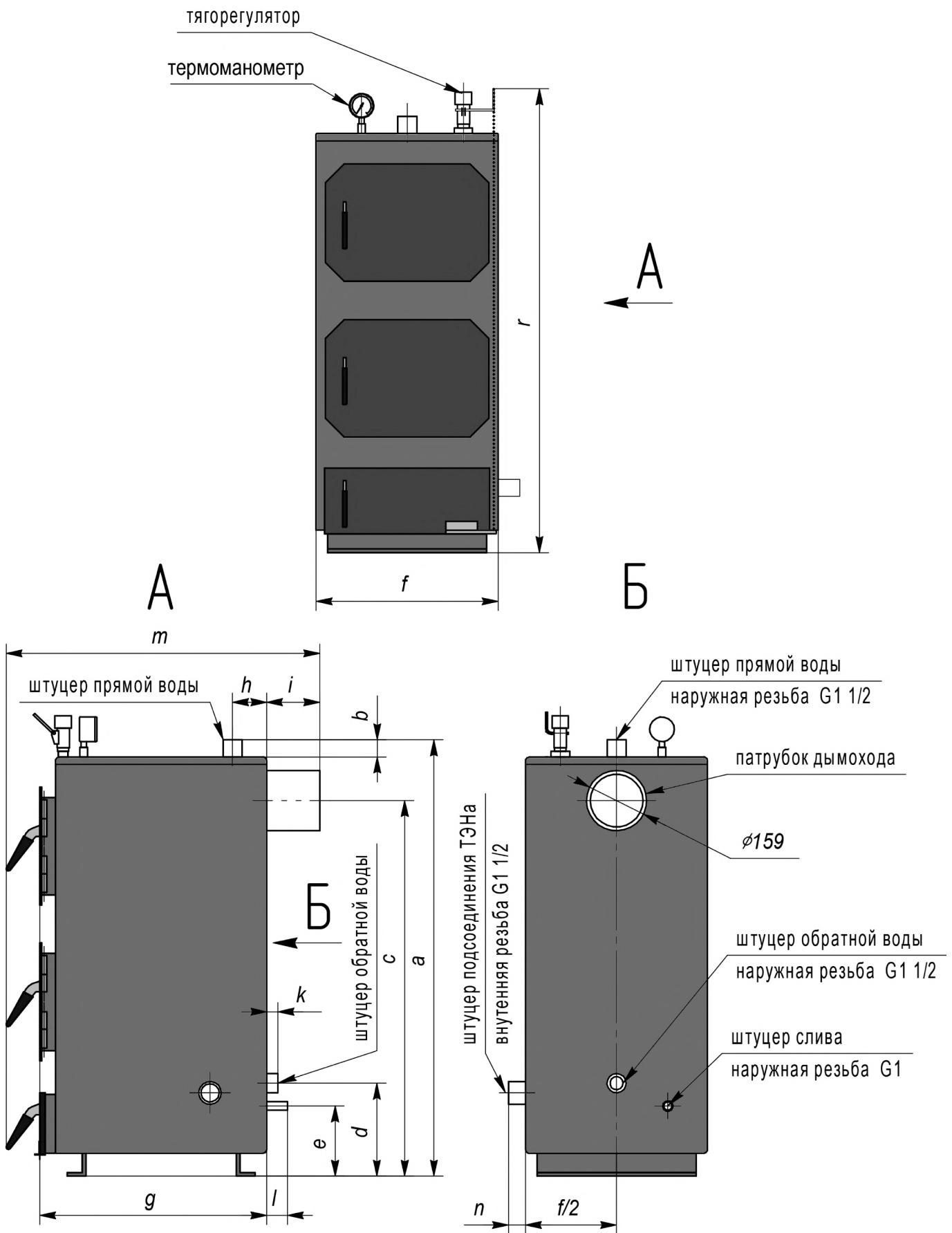
Рисунок 2. Габаритные и присоединительные размеры котлов «ТЕПЛОВЪ» серии «Модернъ» моделей ТМ - 10 ÷ 50 базовой комплектации
