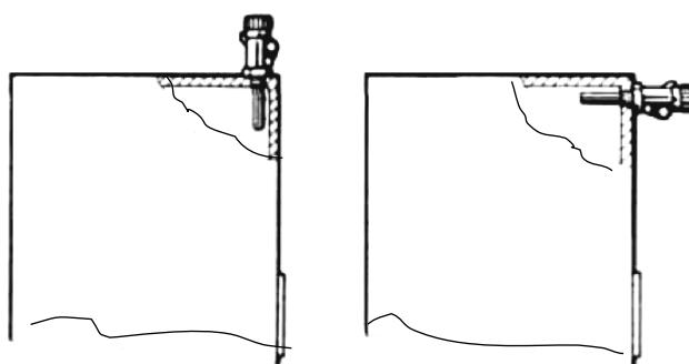
Рисунок 9. Схема размещения тягорегулятора на корпусе Котла
