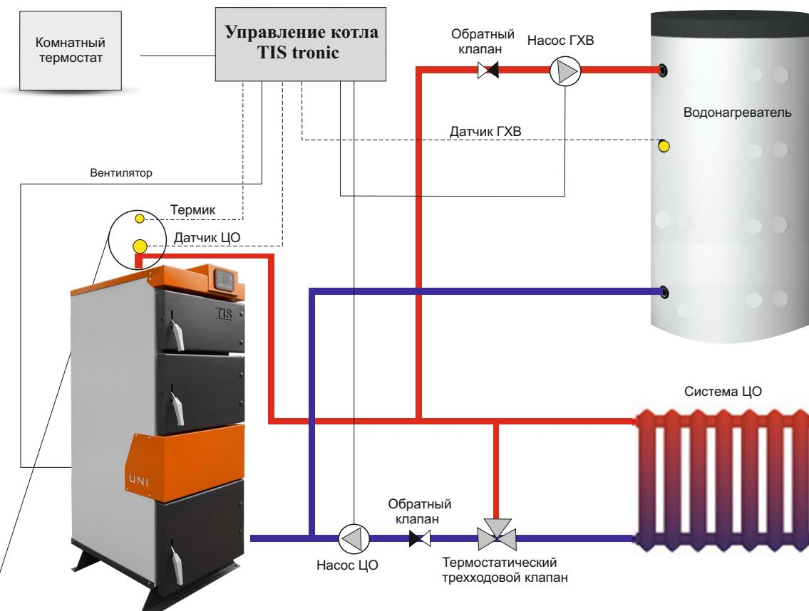
\* Схема подключения (представленная схема является примерной и упрощённой)
